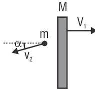
Como não há atrito, não há força de contato na vertical, e portanto a velocidade de saída da barra é toda horizontal. Pela conservação do momento no eixo x,  $m v \cos \theta = M v_1 - m v_2 \cos \alpha$  (I)
