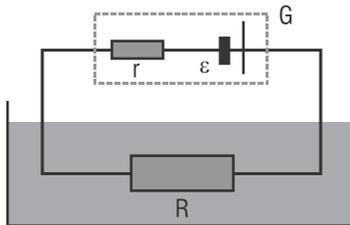
O experimento mostrado na figura foi montado para elevar a temperatura de certo líquido no menor tempo possível, dispendendo uma quantidade de calor  $Q$ . Na figura,  $G$  é um gerador de força eletromotriz  $\epsilon$ , com resistência elétrica interna  $r$  e  $R$  é a resistência externa submersa no líquido. Desconsiderando trocas de calor entre o líquido e o meio externo,
