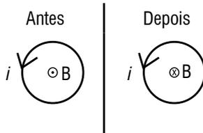
Como  $|B_{\text{fios}} + B_{\text{espira}}| = |B_{\text{espira}}|$ ,  $B_{\text{fios}} = -2 B_{\text{espira}}$  (como  $i_1, i_2 \neq 0, B_{\text{fios}} \neq 0$ ).
