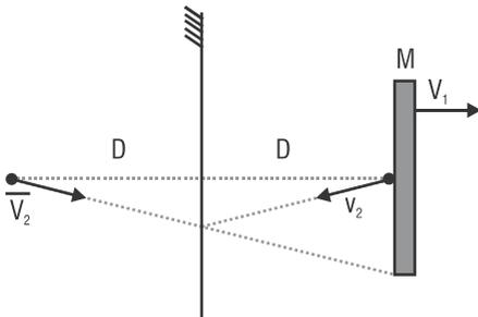
Na horizontal, tudo se passa como se o projétil estivesse a uma distância de 2D da barra (já que a colisão com a parede é elástica sem atrito). É necessário que  $V_2 \cos \alpha > V_1$  e que o tempo até o projétil atingir a mesma posição horizontal da barra  $t = \frac{2D}{V_2 \cos \alpha - V_1}$  seja menor que  $t_{\text{máx}}$ .
