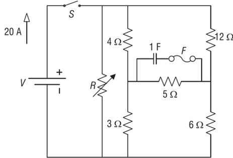
No circuito apresentado na figura acima, a chave  $S$  é fechada e a corrente fornecida pela bateria é  $20\text{ A}$ . Para que o fusível  $F$ , de  $1,5\text{ A}$ , não abra durante o funcionamento do circuito, o valor da resistência variável  $R$ , em ohms, é:
